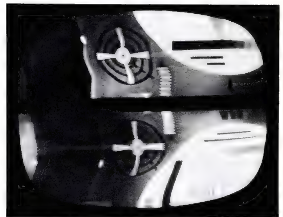
Bild 2. Keine Synchronisation und ein Verzerrten der senkrechten Linien deuten auf eine Verlagerung des Arbeitspunktes des Amplitudensiebes
