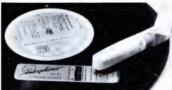
Durch Aufsetzen des Tonabnehmers an der richtigen Stelle kann man den Waagebalken ins Gleichgewicht bringen
