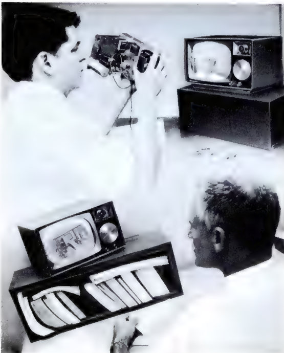
Die beiden Stationen einer von Motorola entwickelten Fernseh-Gegensprechanlage
