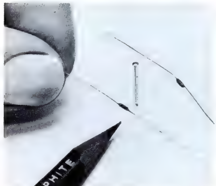
Bild 8. Sehr kleiner hochstabiler Widerstand von Stanley Palmer Ltd.
