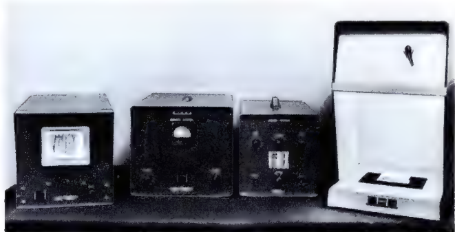
Bild 6. Such- und Rettungs-funkanlage Sarah mit einem 15-W-Sender auf der Frequenz 243 MHz
